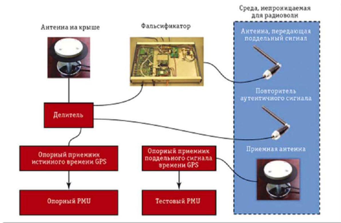
Рис. 1. Тестова система Тихоокеанської національної лабораторії. В ході тестів спостерігалися показання двох PMU при підробці сигналів GPS
