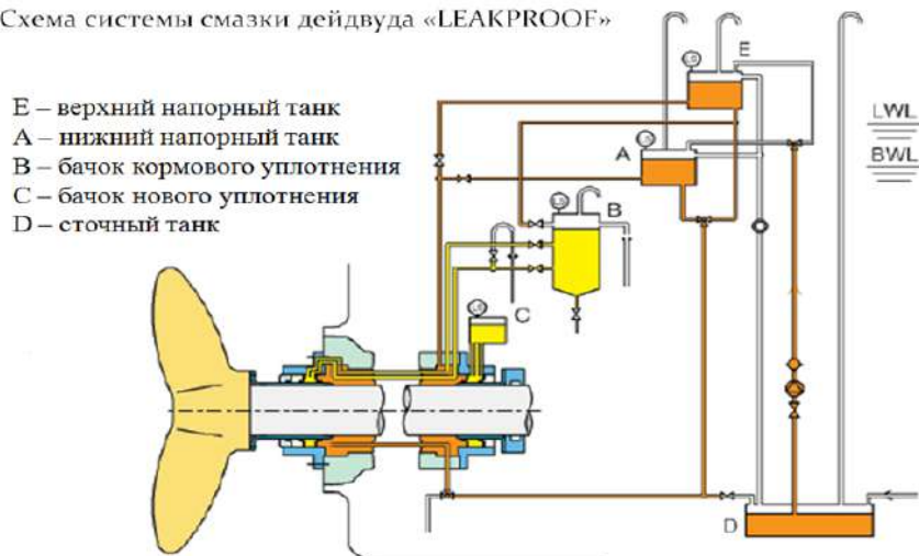
Рис.5 Схема системи змащення дейдвуда “LEAKPROOF” [6]
