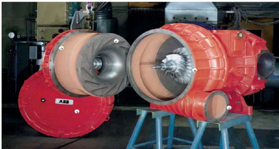
Рис. 1. Частково розібраний VTR 354-11 турбокомпресора.
